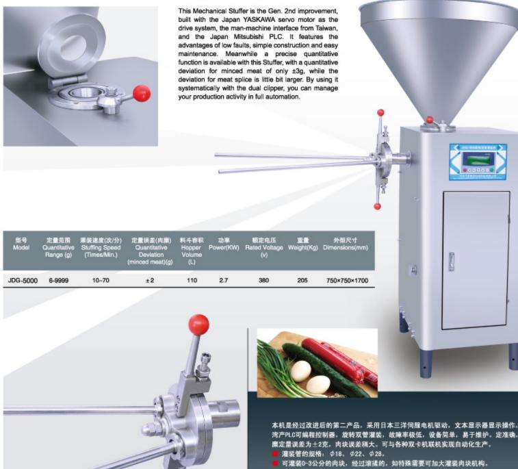
本机是经过改进后的第二产品,采用日本三洋伺服电机驱动,文本显示器显示操作,台 湾产PLC可编程控制器,旋转双管灌装,故障率极低,设备简单,易于维护。定准确,肉
