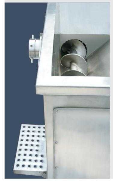
此机可将未解冻的肉块直接进行绞切,减少肉的营养成分和蛋白的损失,通过配换孔刀生产不同的肉糜和肉块产品。 不损害肌肉纤维组织,对产品无明显升温,延长产品的保质期,为下道工序做好前期准备工作。
