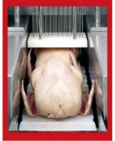
本机可根据产品和工艺要求调节步进速度和行程。将盐水及编料配制的腌渍剂均匀的注射到大小肉块和带骨肉中,缩短了腌渍时间。72针同时注射,注射压力可根据需要大小可调,并配有乳化装置。可将淀粉、蛋白等添加剂充分研磨。不产生颗粒。 倾斜的贮水回流桶和配套的搅拌功能有效的防止物料的沉淀。本机设计合理,链排可拆卸,清洗方便,提高肉制品质量及产量的理想设备。在国内享有极高的美誉。
