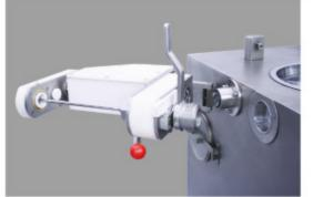
本机控制系统采用自主研发的数控系统,采用5.7吋真彩液晶显示屏、P C程序控制、前面板防水设计,控制界面采 用人性化设计直观明了。传动系统采用日本安川伺服电机和德资产减速机,德国产真空泵。此机在真空状态下完成 定量灌装和高速扭结,防止了脂肪氧化,避免蛋白质水解,减少细菌存活量,有效的延长了产品的保质期。
